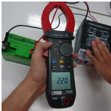
รูปที่ 2 วัดกระแสไฟฟ้าที่ไหลเข้าไปในแบตเตอรี่
