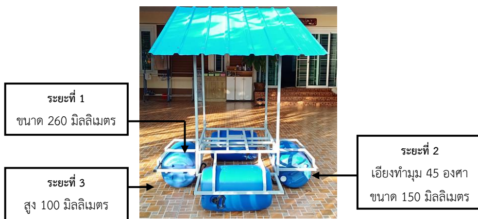
ภาพที่ 4 โครงสร้างระบบสูบน้ำแบบแพลอยน้ำพลังงานแสงอาทิตย์
