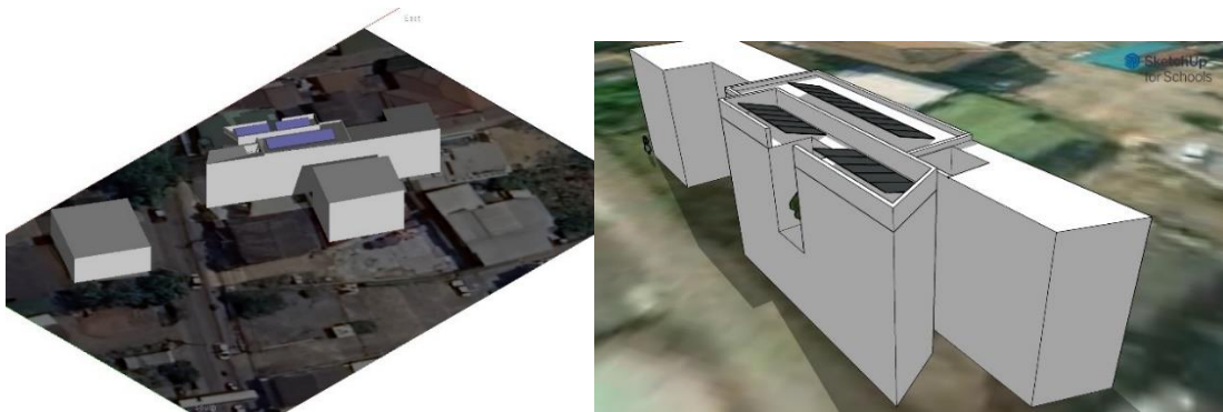
ภาพที่ 5 แบบจำลองทิศทางและการเอียงของแผง PV สำหรับโปรแกรม PVsyst
