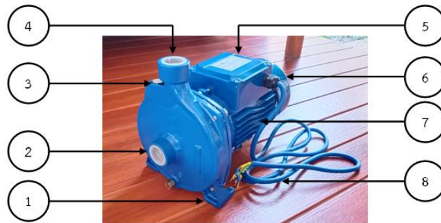
ภาพที่ 1 เครื่องสูบน้ำแบบหอยโข่งมอเตอร์ไฟฟ้ากระแสตรงขนาด 550 วัตต์
