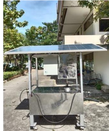
ภาพที่ 1 เครื่องขึ้นรูปภาชนะจากวัสดุธรรมชาติโดยใช้พลังงานหมุนเวียน
