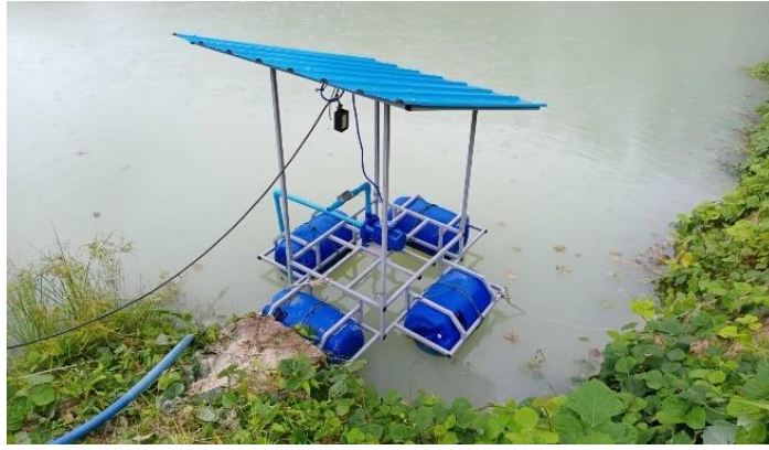
ภาพที่ 5 การติดตั้งแพลอยน้ำในพื้นที่แหล่งน้ำ
