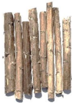
ภาพที่ 2 (ก) ก้านดอกทานตะวันที่ทำการตากแห้งแล้ว (ข) ก้านดอกทานตะวันที่มีเปลือกก้านหุ้มแก่นรูปพุนภายในก้าน
