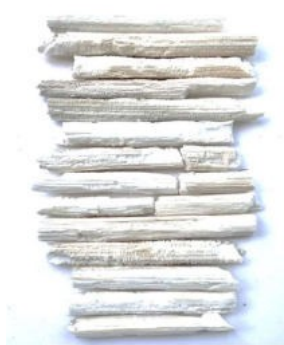
ภาพที่ 3 ลักษณะส่วนประกอบของก้านดอกทานตะวันที่ประกอบด้วย (ก)แก่นรูปพุนภายในก้าน และ(ข)เปลือกก้าน
