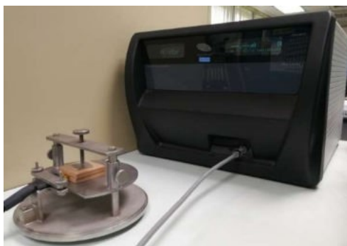
ภาพที่ 13 เครื่องทดสอบ Hot Disk Thermal Constant Analyser และลักษณะการวางแผ่นชิ้นงานทดสอบ
