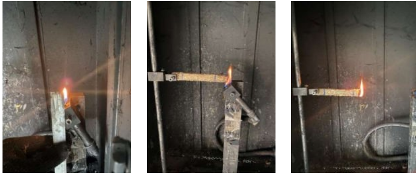
ภาพที่ 10 การทดสอบการลามไฟแนวนอน ตามมาตรฐาน UL-94
