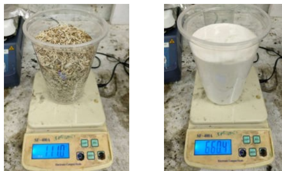
ภาพที่ 6 การชั่งตวงส่วนผสมอัตราส่วนของเศษก้านดอกทานตะวัน ต่อ น้ำยางพารา
