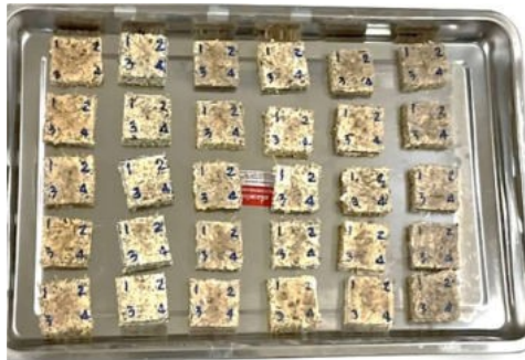
ภาพที่ 9 ขนาดชิ้นงานที่ใช้ในการทดสอบหาค่าความหนาแน่น ปริมาณความชื้น การพองตัวและค่าการนำความร้อน
