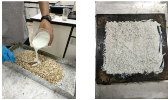
ภาพที่ 7 การผสมอัตราส่วนของเศษก้านดอกทานตะวัน ต่อน้ำยาง และการเทใส่แม่พิมพ์
