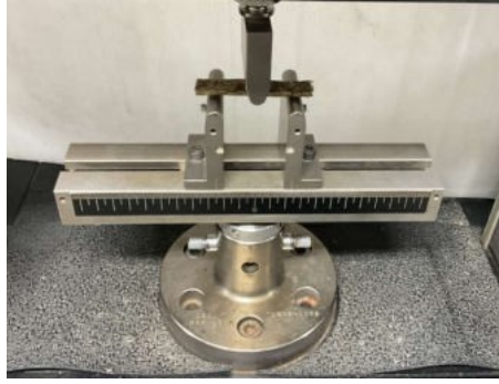
ภาพที่ 12 ลักษณะการวางชิ้นทดสอบ และการกวดทดสอบการติดตั้ง
