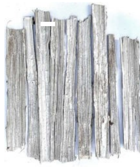
ภาพที่ 3 ลักษณะส่วนประกอบของก้านดอกทานตะวันที่ประกอบด้วย (ก)แก่นรูปพุนภายในก้าน และ(ข)เปลือกก้าน
