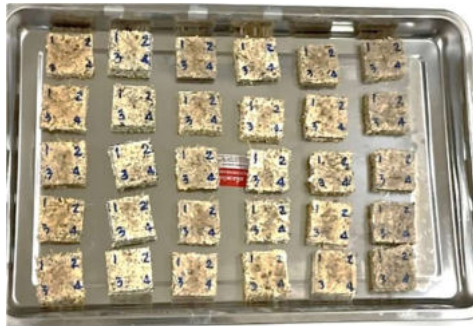
ภาพที่ 9 ขนาดชิ้นงานที่ใช้ในการทดสอบหาค่าความหนาแน่น ปริมาณความชื้น การพองตัวและค่าการนำความร้อน
