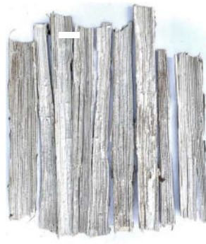
ภาพที่ 3 ลักษณะส่วนประกอบของก้านดอกทานตะวันประกอบด้วย (ก).แก่นรูปทรงแท่งภายในก้าน และ(ข).เปลือกก้าน
