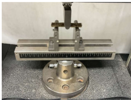
ภาพที่ 12 ลักษณะการวางชิ้นทดสอบ และการกดทดสอบการติดตั้ง
