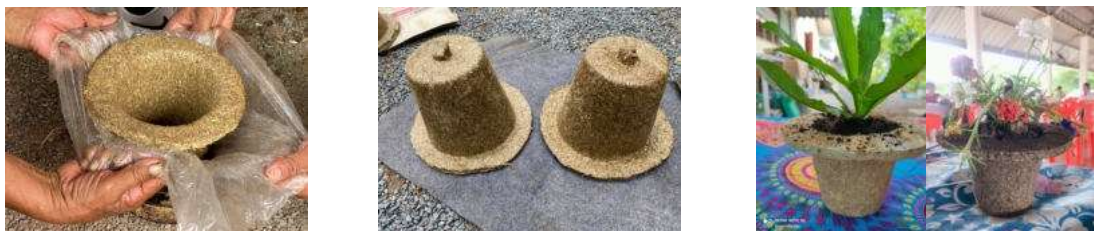
ก. เกาะกระถางออกจากแม่พิมพ์ ข. นำกระถางไปตากแดด ค. กระถางสามารถนำไปเพาะต้นไม้ได้
