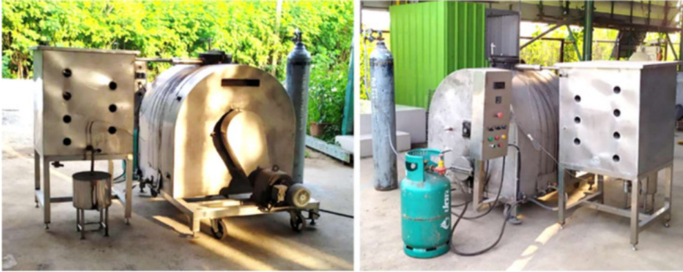
ภาพที่ 2 ชุดทดสอบกระบวนการไพโรไลซิสแบบเบดเคลื่อนที่
