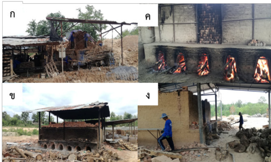
ภาพที่ 1 ภาพกิจกรรมภายในโรงงานอิฐมอญตะวัน ตำบลหนองหล่ม อำเภอห้างฉัตร จังหวัดลำปาง (ก) การปั้นอิฐ, (ข) เตาเผาแบบดั้งเดิม, (ค) การเผาอิฐแบบสูมไฟ และ (ง) การเติมเชื้อเพลิงชีวมวล
