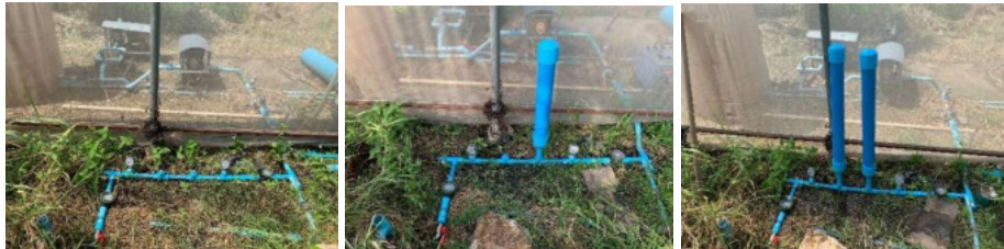
ภาพที่ 4 เครื่องสูบน้ำสูบชักแบบไม่ใส่ท่อพักอากาศ ใส่ท่อพักอากาศ 1 ท่อ และ ใส่ท่อพักอากาศ 2 ท่อ
