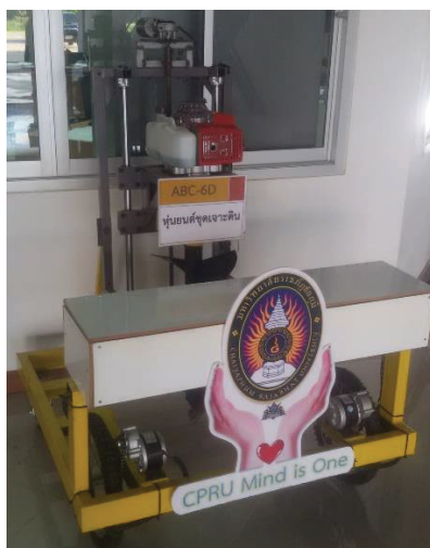
ภาพที่ 2 โครงสร้างหุ่นยนต์ชุดเจาะเพื่อการเกษตร (โครงสร้างจริง)
