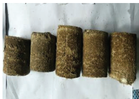
ภาพที่ 2 ขั้นตอนในการผลิตเชื้อเพลิงชีวอัดแท่งจากมูลช้าง
