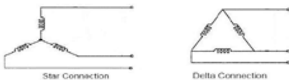
รูปที่ 2 การต่อขดลวดแบบสตาร์และเดลต้า
