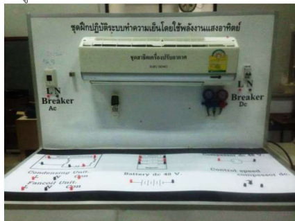
รูปที่ 12 ชุดระบบปรับอากาศคอมเพรสเซอร์กระแสตรงโดยใช้ พลังงานแสงอาทิตย์
