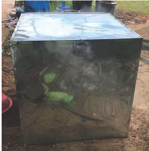
ภาพที่ 8 โครงสร้างตู้อบรมควันแบบเสร็จสมบูรณ์
